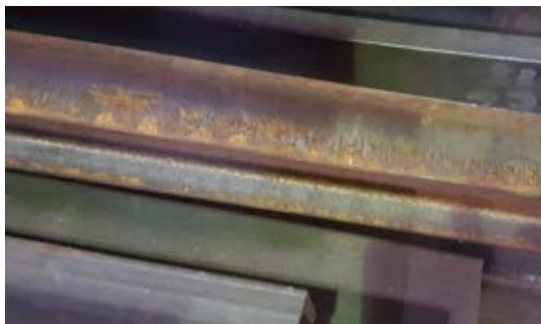
Walzzunder und Korrosion an Rohmaterialien
