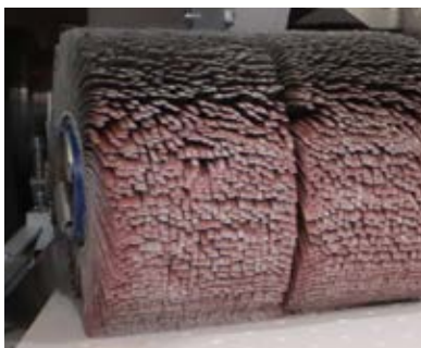
Schleiflamellenwalze (Quelle: www.blech-entgratung.de)
